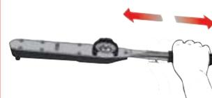
L'utilisation du principe de torsion permet de tenir la clé où l'on veut même avec 2 mains ou une rallonge.
