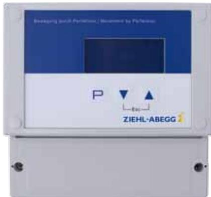
Anzeige und Bedienterminal zur Parametrierung und Bedienung der Basic Frequenzumrichter „Icontrol Basic“ und „Fcontrol Basic“ (auch zur Parametrierung und Bedienung von ECblue Ventilatoren). Die Basic Frequenzumrichter ohne integriertes Display, haben einen Steckplatz für die Add On Module AM-Premium. Durch Einstecken der Add On Module kann das Bedienterminal AXG-1A(E) oder das Handterminal A-G-247NW angeschlossen werden.
