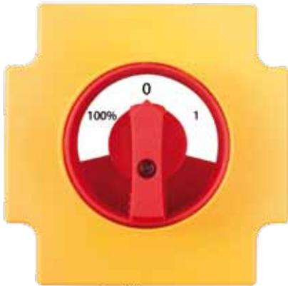
Die Hauptschalter haben drei Schalterstellungen. In Stellung 1 bzw. Auto wird ein angeschlossener Frequenzumrichter versorgt. Der geregelte Ausgang des Frequenzumrichters geht zurück auf den Schalter, der beispielsweise Ventilatoren damit versorgt.
